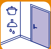
Houd tijdens douchen en koken de deuren dicht en zet de mechanische ventilatie op de hoogste stand of open ramen na afloop
