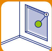
Laat ventilatie- roosters in ramen open en dek ze niet af
