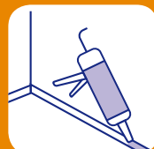
Dicht kieren in de begane grond vloer (zoals rondom de meterkast en kruipruimte)
